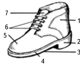
Рис. 170. Ботинок: 1 — берца; 2 — каблук; 3 — подошва; 4 — рант; 5 — носок; 6 — блочки; 7 — язычок
